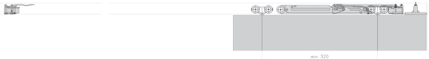
**Dämpfen in Schließ- und Öffnungsrichtung**
