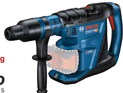
**Akku-Bohr-/Meißelhammer GBH 18V-45 C, solo** (ohne Akku/ohne Ladegerät) im Handwerkerkoffer, BITURBO, mit SDS-max Aufnahme, Schlagenergie 12,5 J, Nenndrehzahl 0 - 305 U/min., max Bohr-Ø in Beton/Mauerwerk 45 mm
