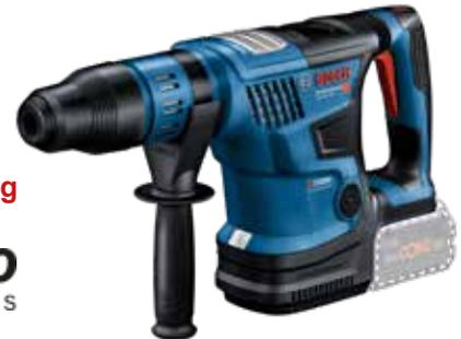
**Akku-Bohr-/Meißelhammer GBH 18V-40 C, solo** (ohne Akku/ohne Ladegerät) im Handwerkerkoffer, BITURBO, mit SDS-max Aufnahme, Schlagenergie 9,0 J, Nenndrehzahl 0 - 360 U/min., max Bohr-Ø in Beton 40 mm
